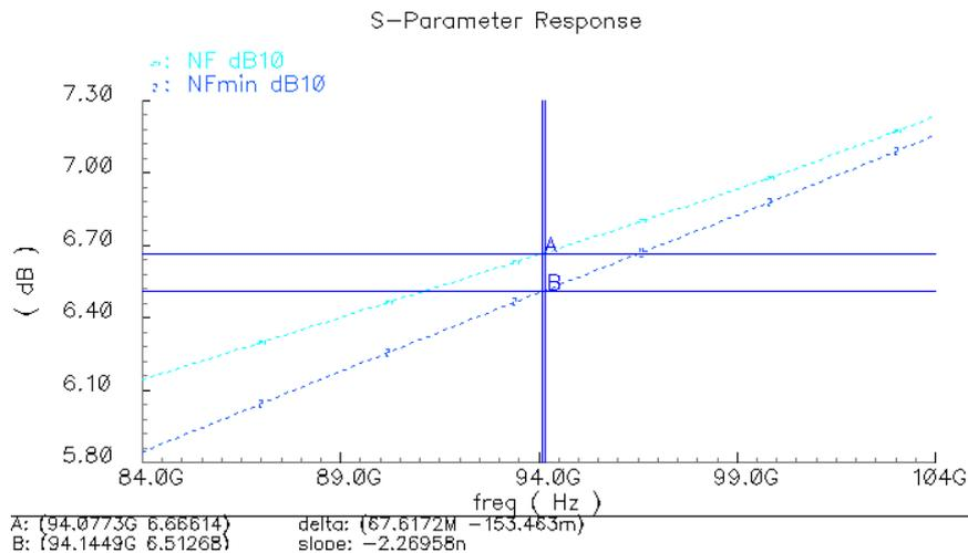
Figure 3.22 NFmin, NF of the LNA
