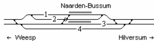
Figuur 2-4 Spoorlay-out station Naarden-Bussum
