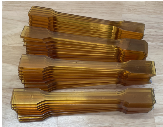
Figure 2.6.: Tensile bars of Ultem (n=38).
