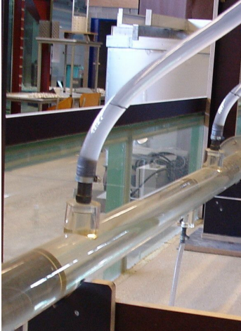
Figuur 4-14: Links, regenkolkaansluiting op de rioolbuis. De aansluiting bestaat uit een flexibele slang met een binnendiameter van 25mm. Deze is aangesloten op een Pvc-slangaansluiting met een inwendige diameter van 19 mm. De gaten geboord in de aangesloten rioolbuis zijn scherp en haaks.
