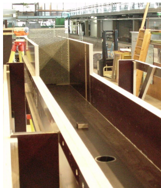
Figuur 4-12: Links, inlaatbassin van de straat, met piepschuim na de onderlaat waarmee de stroming wordt gereguleerd.
