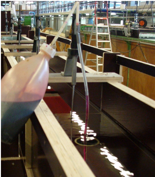
Figuur 5-4: Links: injectie van kleurstof in putje Figuur 5-5: Rechts: stroming van kleurstof door slang.
