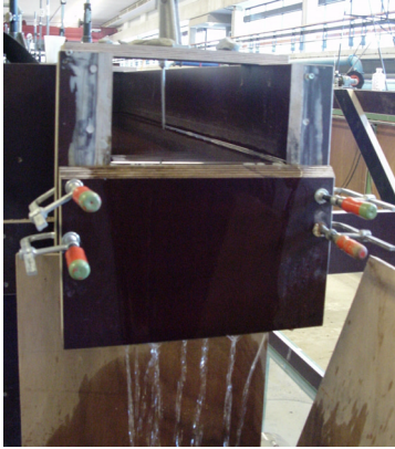
Figuur 4-6: Links, instelling benedenstroomse waterstand op de straat. Met plaat van betonplex kan een hoge waterstand worden ingesteld. Deze plaat wordt vastgezet met 4 lijmklemmen en waterdicht gemaakt met mandoline (klei).
