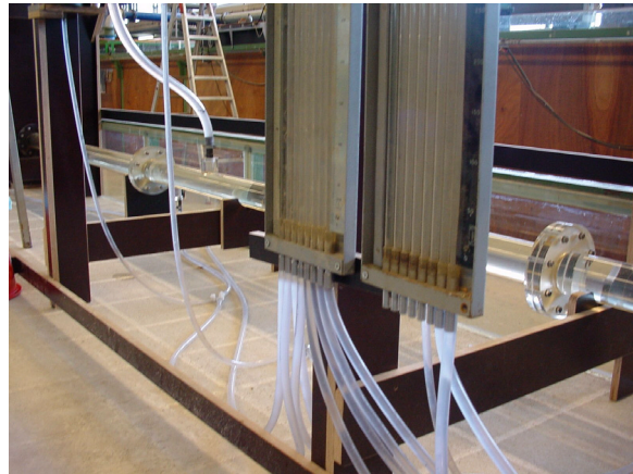
Figuur 4-22: Foto met manometerbord en drukpotje met peilnaald. Tevens zijn de peilnaalden op de straat te zien.
