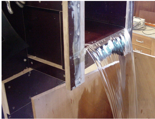
Figuur 4-6: Links, instelling benedenstroomse waterstand op de straat. Met plaat van betonplex kan een hoge waterstand worden ingesteld. Deze plaat wordt vastgezet met 4 lijmklemmen en waterdicht gemaakt met mandoline (klei).
