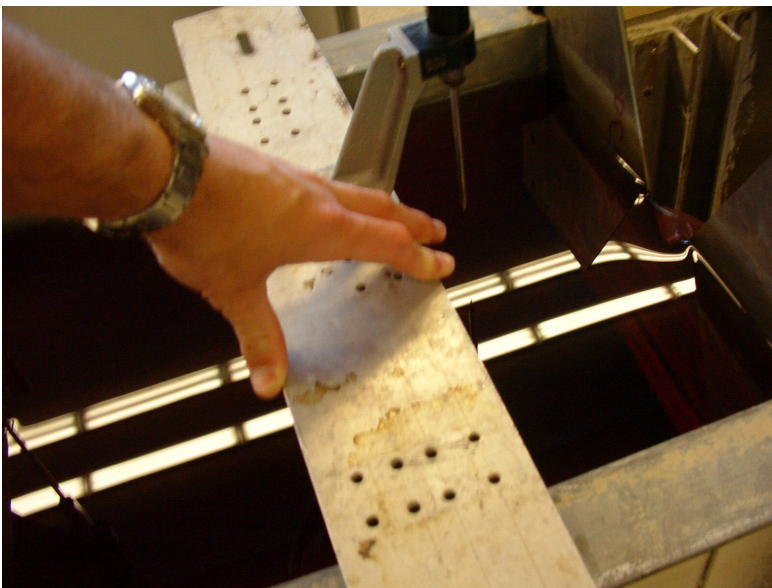
Oefen een beetje druk uit op 1 zijde van de aluminium balk.
