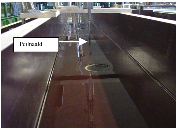
Figuur 4-24: Op de straat is de waterhoogte direct gemeten met peilnaalden, deze staan in het midden van de straat gemonteerd op 25 cm bovenstrooms van de regenkolken.
