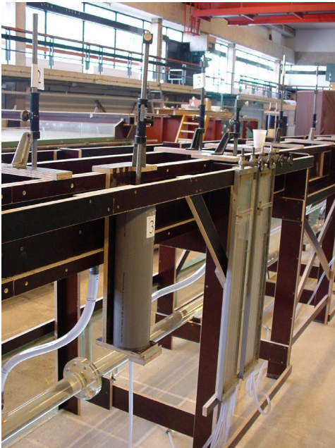
Figuur 4-22: Foto met manometerbord en drukpotje met peilnaald. Tevens zijn de peilnaalden op de straat te zien.
