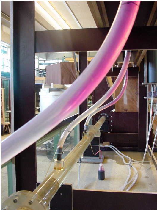
Figuur 5-3: Grote snelheidsverschillen in kolkaansluiting zichtbaar gemaakt door kleurstof.
