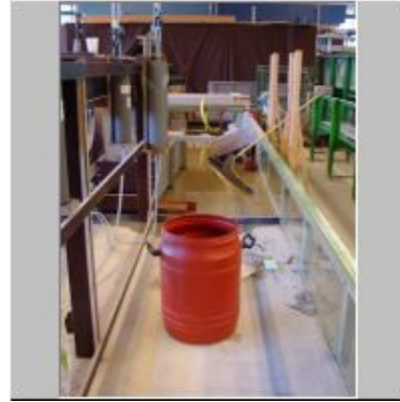
vat gebruikt tijdens massakalibratie grote debieten.jpg 1.11 MB
