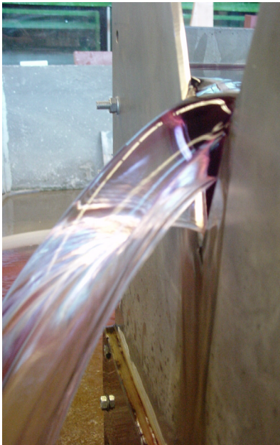
Figuur 5-1: Links: Overstortende straal met aankleving aan de zijkant en lekkend water recht onder de hals van de V.
