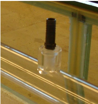
Figuur 4-17: Foto met slang aansluiting van riool t.b.v. aansluiting regenkolk. Zonder gemonteerde verbindingsslangen
