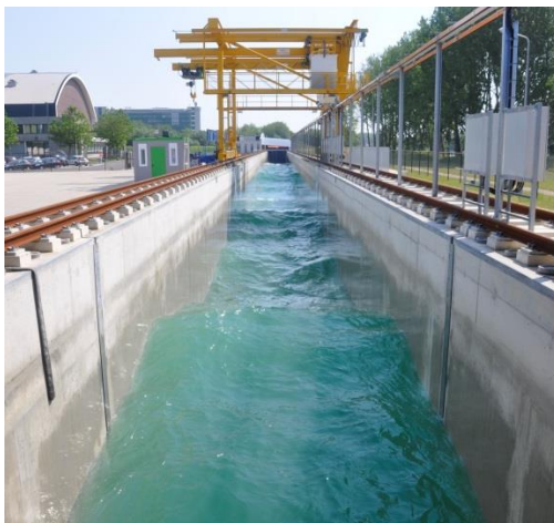
Figuur 1.1 Links: naderende golven in de Deltagoot te Delft. Rechts: golfaanval op de Basalton 30 STS+ steenzetting tijdens proef B11.
