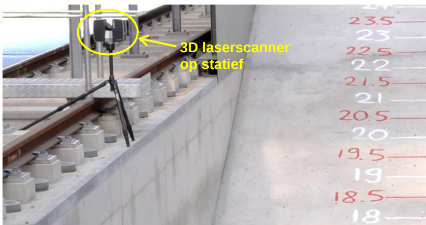
Figuur 3.9 Voor het inmeten van het taludoppervlak is gebruikgemaakt van een 3D laserscanner.
