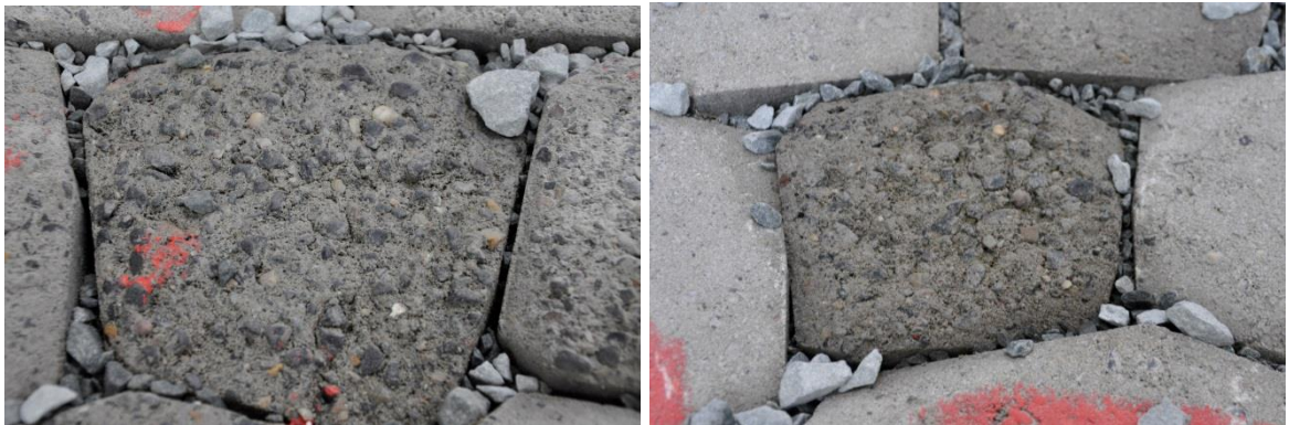
Figuur 4.4 Het bovenvlak van sommige zuilen was afgesleten na proef B03.
