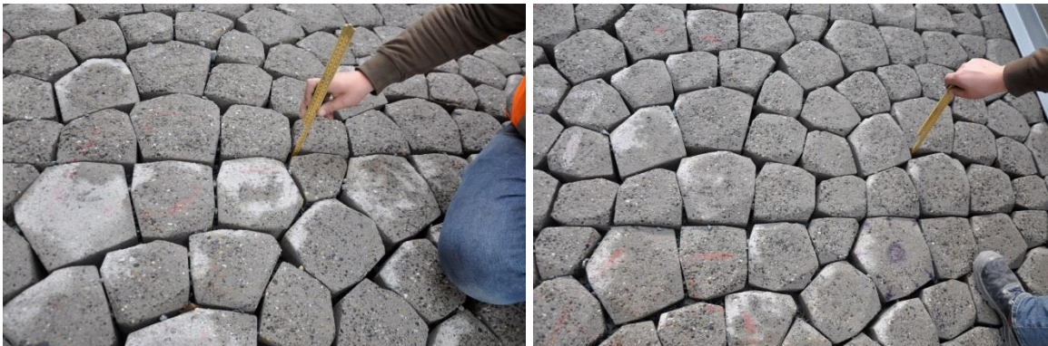
Figuur 4.9 Meting van de uitspoeldiepte na proef B07. Links is circa 18 cm gemeten en rechts circa 19 cm.
