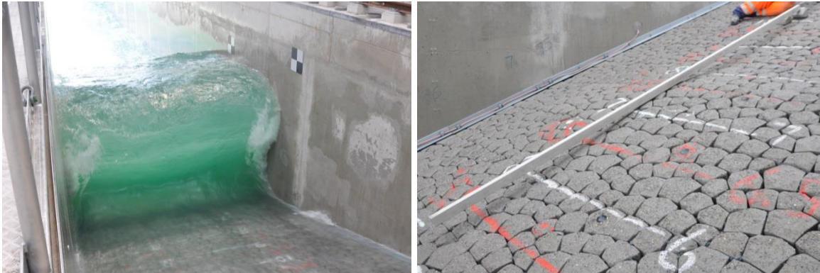
Figuur 4.13 Links: golfaanval tijdens proef B12. Rechts: vervorming van de steenzetting na proef B12.
