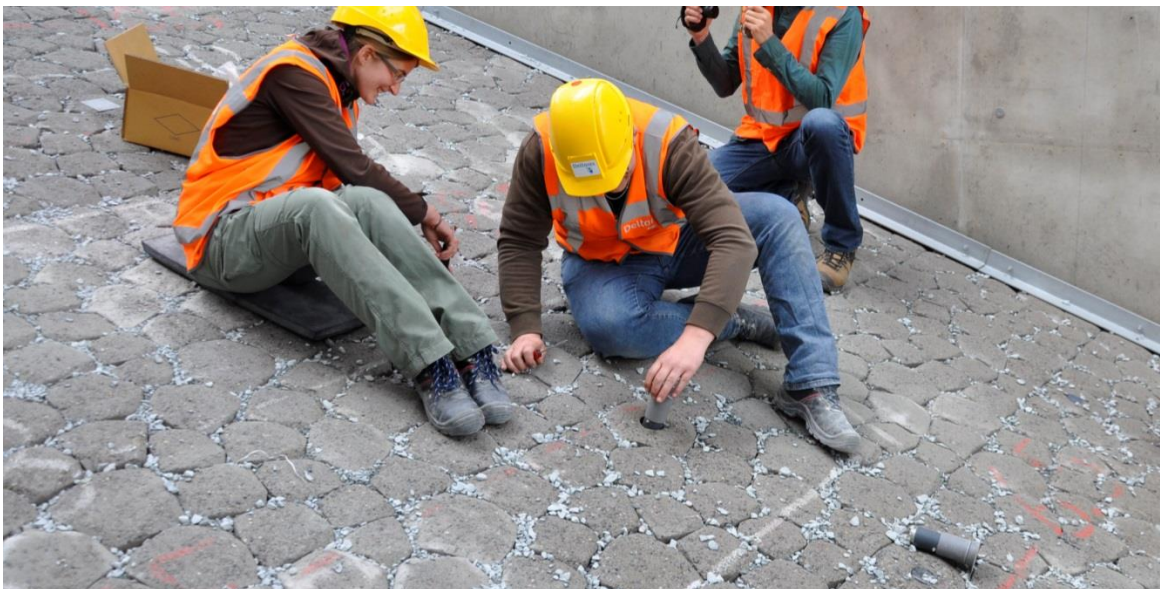
Figuur 3.11 De versnellingsopnemers zijn aangebracht binnenin uitgeboorde Basalton 30 STS+ zuilen. Na elke proef zijn ze uit de zuilen gehaald voor het uitlezen van de meetdata.
