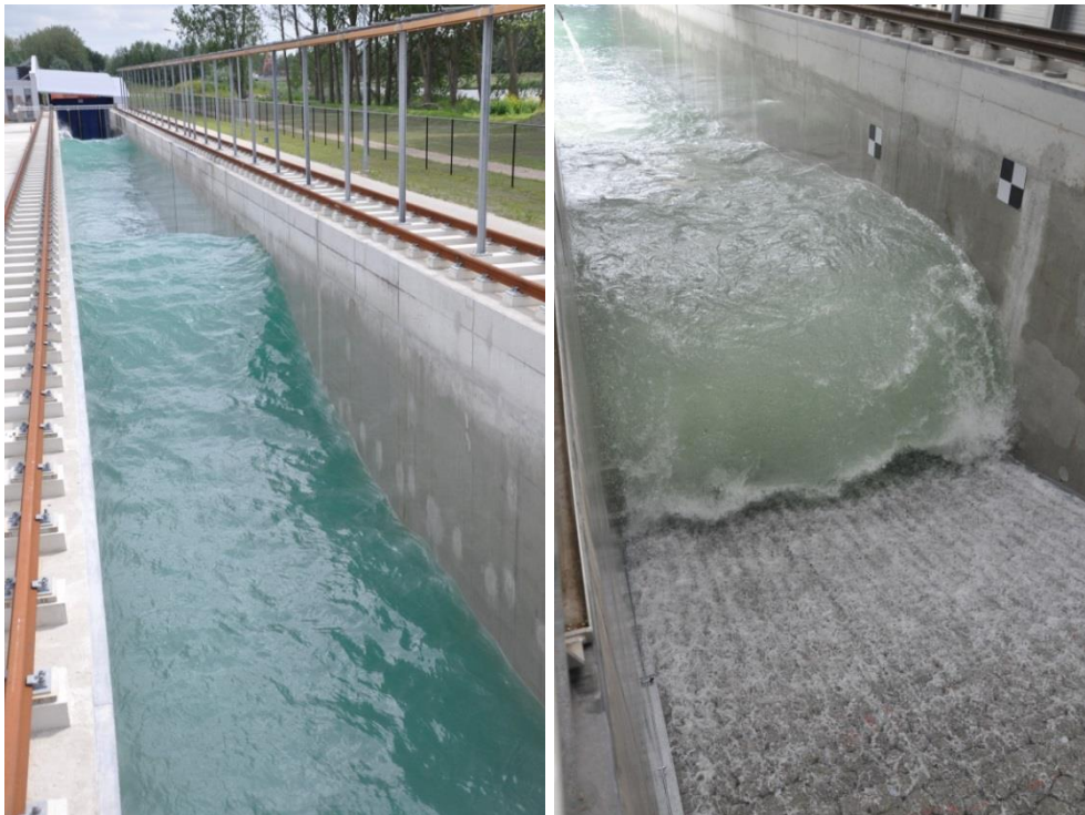
Figuur 4.7 Links: inkomende golven tijdens proef B07. Rechts: golfaanval tijdens proef B07.
