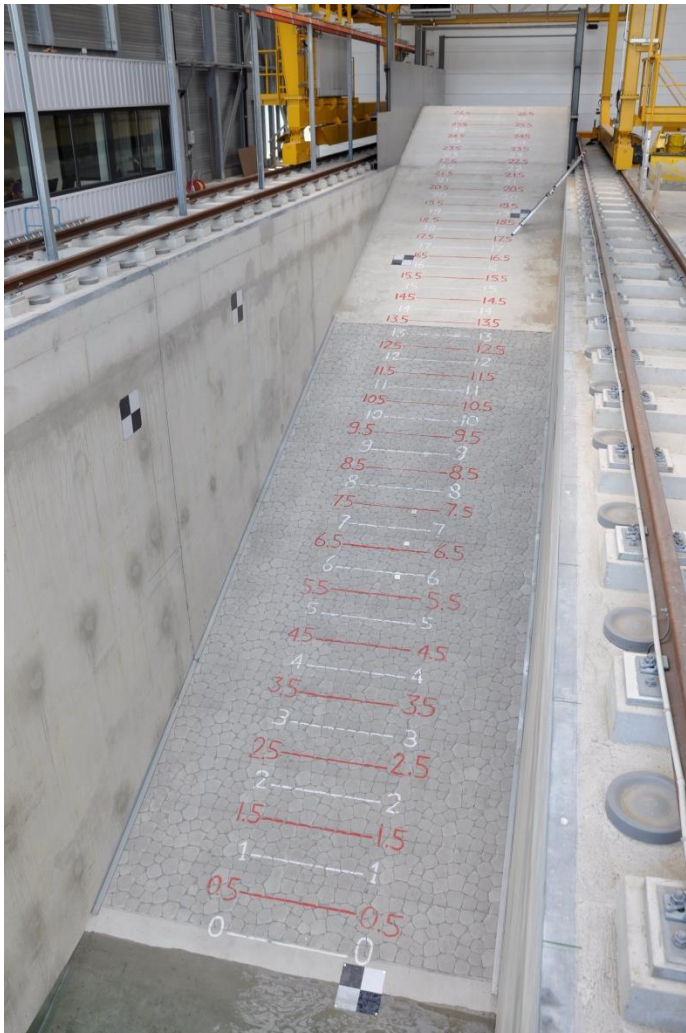
Figuur 3.1 Overzicht van de modelopstelling met Basalton 30 STS+ zuilen, voorafgaand aan serie 1.
