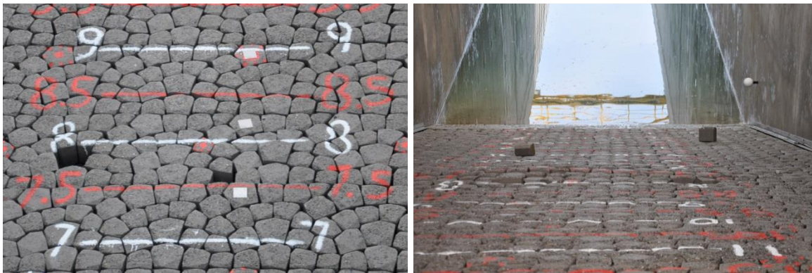
Figuur 4.16 De steenzetting na proef B14.
