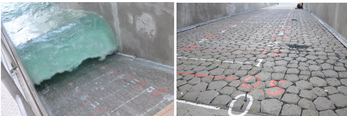
Figuur 4.10 Links: brekende golf tijdens B09. Rechts: de steenzetting na proef B09.
