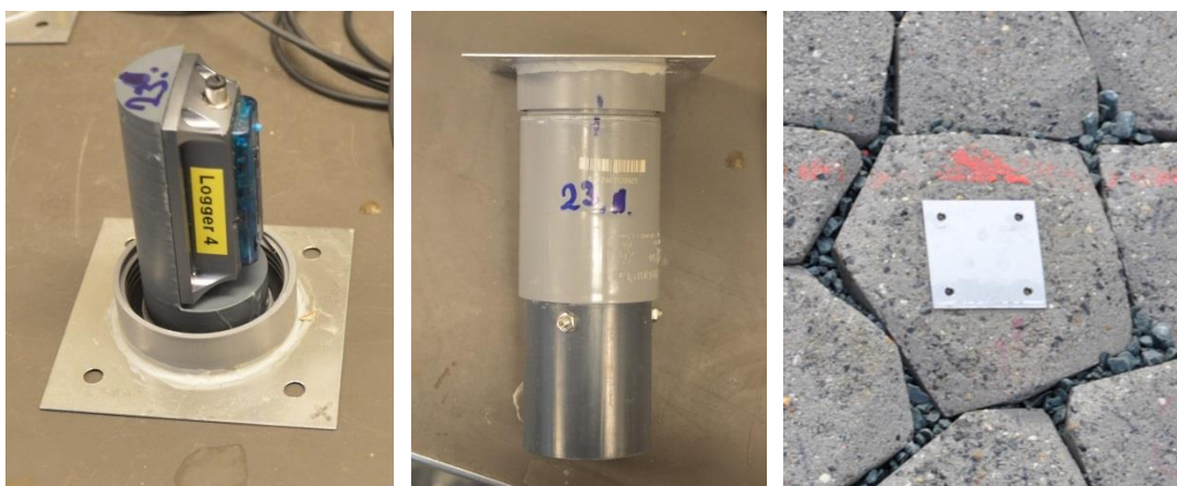
Figuur 3.10 Links: een versnellingsopnemer. Midden: de versnellingsopnemer is ingebouwd in de behuizing.
