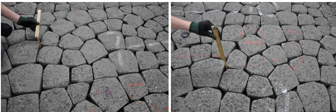
Figuur 4.6 Meting van de uitspoeldiepte van het inwasmateriaal na proef B06. Links is circa 19 cm gemeten en rechts circa 17 cm.
