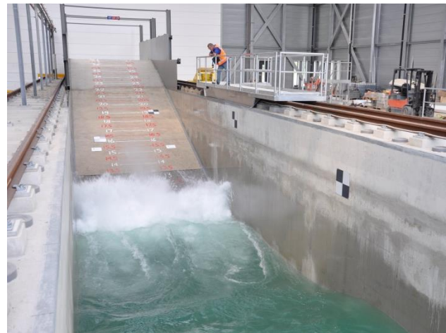
Figuur 1.1 Links: naderende golven in de Deltagoot te Delft. Rechts: golfaanval op de Basalton 30 STS+ steenzetting tijdens proef B11.
