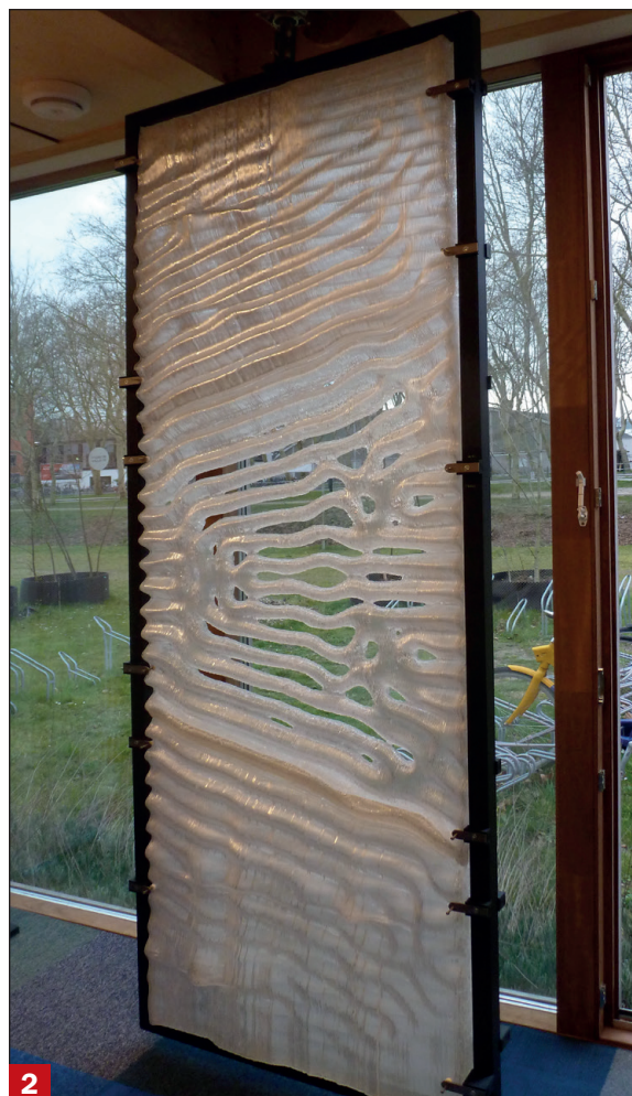
2 Een moderne Trombe wand op basis van faseveranderingsmateriaal, ontwikkeld binnen het Double Face 2 project aan de TU Delft.
