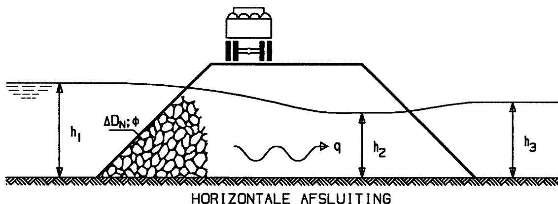
Figuur 4.1a Relevante constructie-parameters horizontale afsluiting
