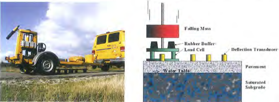
Figuur 8 Het bepalen van grondeigenschappen uit de registraties van een valgewichtproef in de wegbouw is een complex dynamisch probleem.
