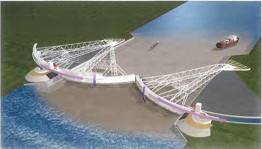
Figuur 4. Maeslantkering in Nieuwe Waterweg. Gigatechnologie in de waterbouw.
