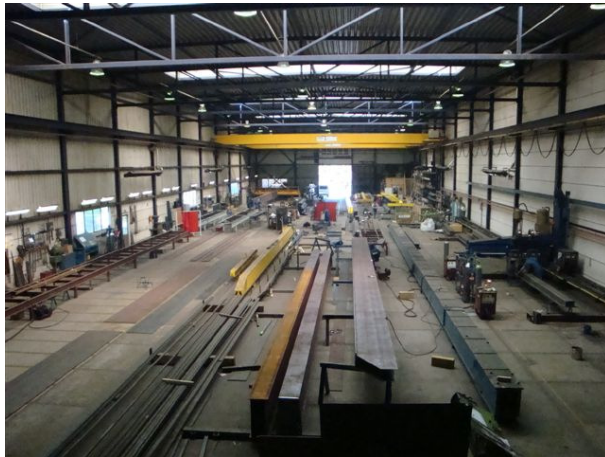
Figuur 22 Voorbeeld van een gebouw met een vuurbelasting < 95 \text{ MJ/m}^2 , op de foto een productiehal van (stalen) kraanbanen
