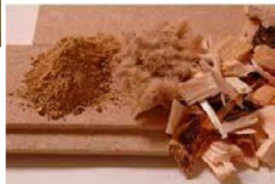
afbeelding 4.15 Referentie houtvezelisolatie met leemafwerking, ecologischbouwen.be
