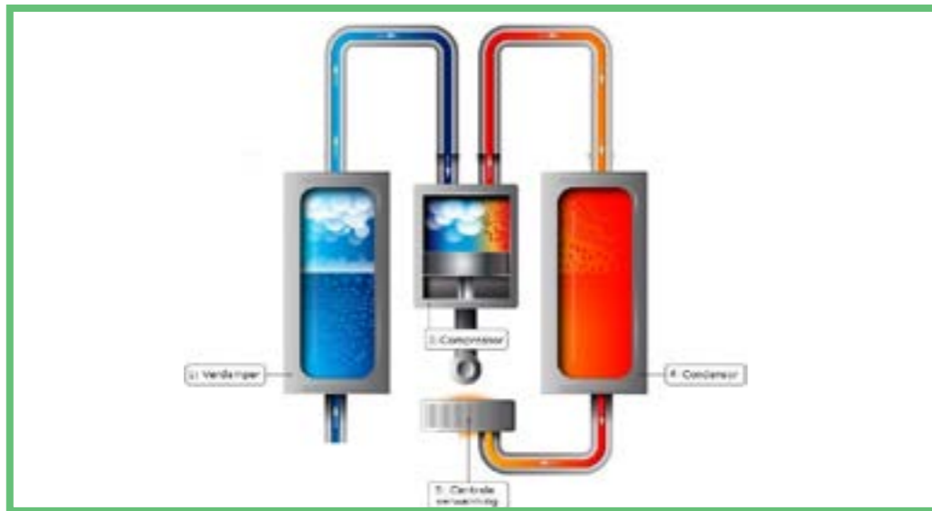
afbeelding 4.22 Werking van een warmtepomp, duurzaambouwloket.nl
