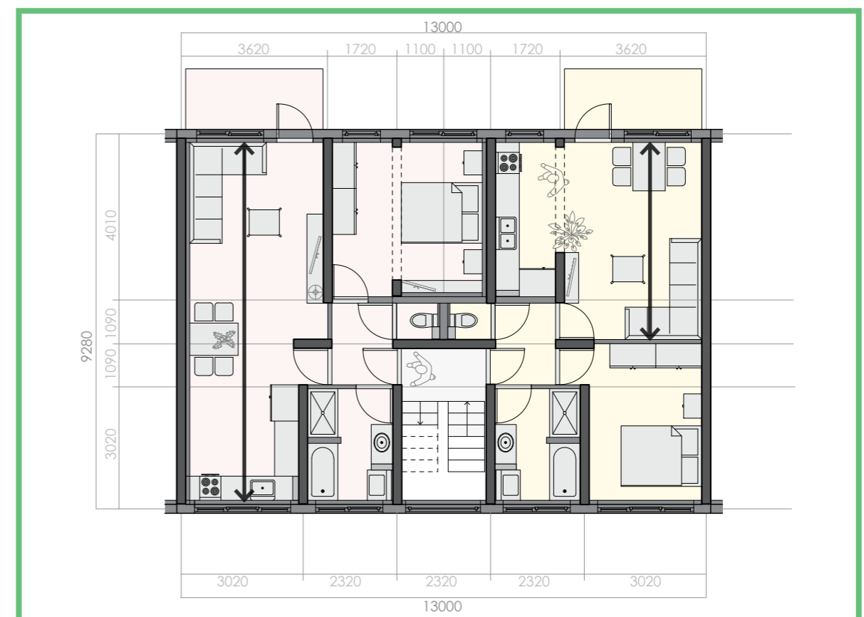
afbeelding auteur. 3.17 Celsgewijze renovatie bij woningtypen Brinkman & van den Broek. bij woning 1 is een doorzon woonkamer mogelijk door gebruik van de wisselbeuk voor de hoofslaapkamer, bij woning 2 moet de hoofslaapkamer in de brede beuk.
