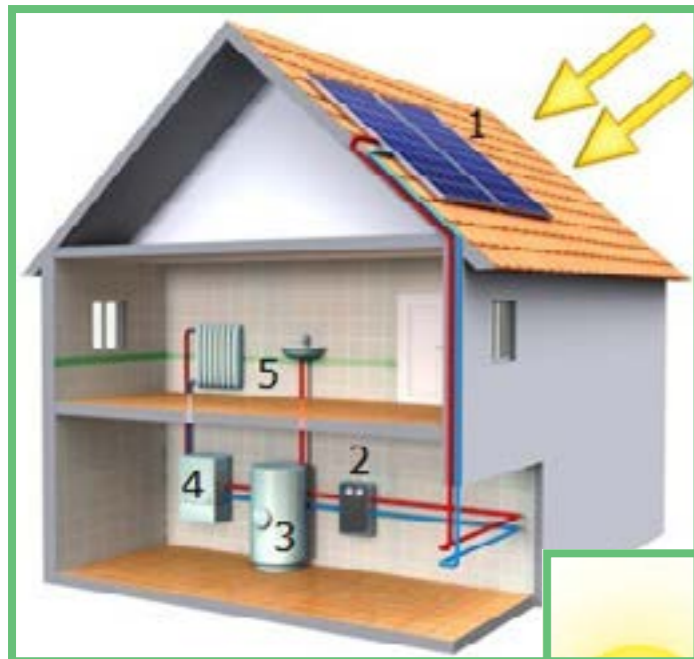
afbeelding 4.20 Werking van zonneboilers duurzaambouwloket.nl
