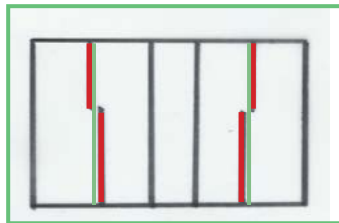
afbeelding auteur 4.6 Verspringing draagmuur
