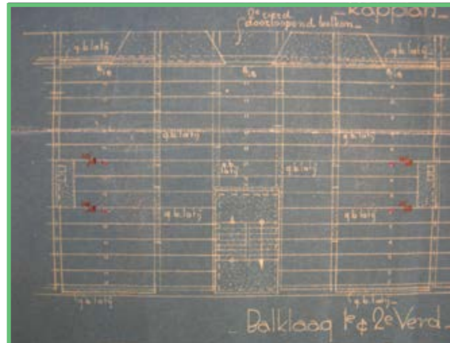
afbeelding 3.13 balklaag van de vloerconstructie, draagmuren en stabilisatiewanden van de drie typen.
