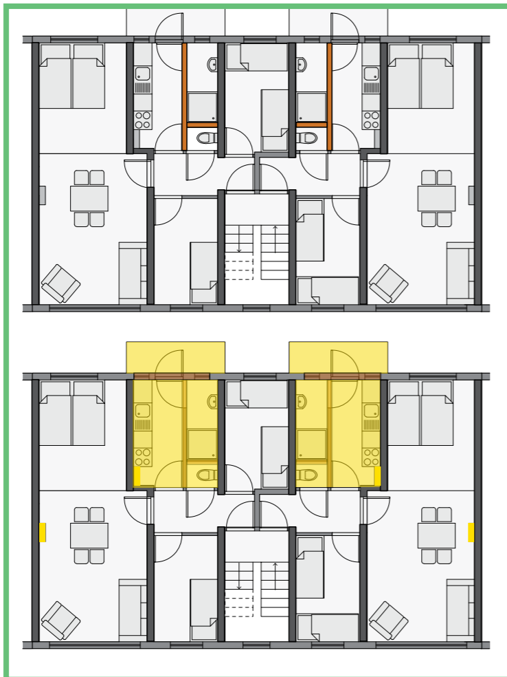
afbeelding auteur 4.26 Sloopfase woningverbetering. binnenmuren, keuken, balkon en leidingschachten
