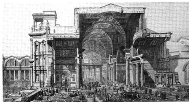
136. De thermen van Caracalla te Rome. 215 nC. a. Plattegrond volgens Durm. b. Het tepidarium (centrale hal) volgens Blouet.
