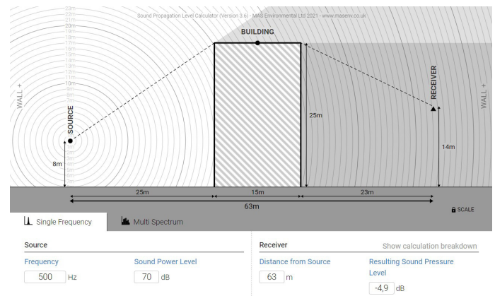
Fig 36. Sound measurements diagram Het Funen (NoiseTools, n.d.)
