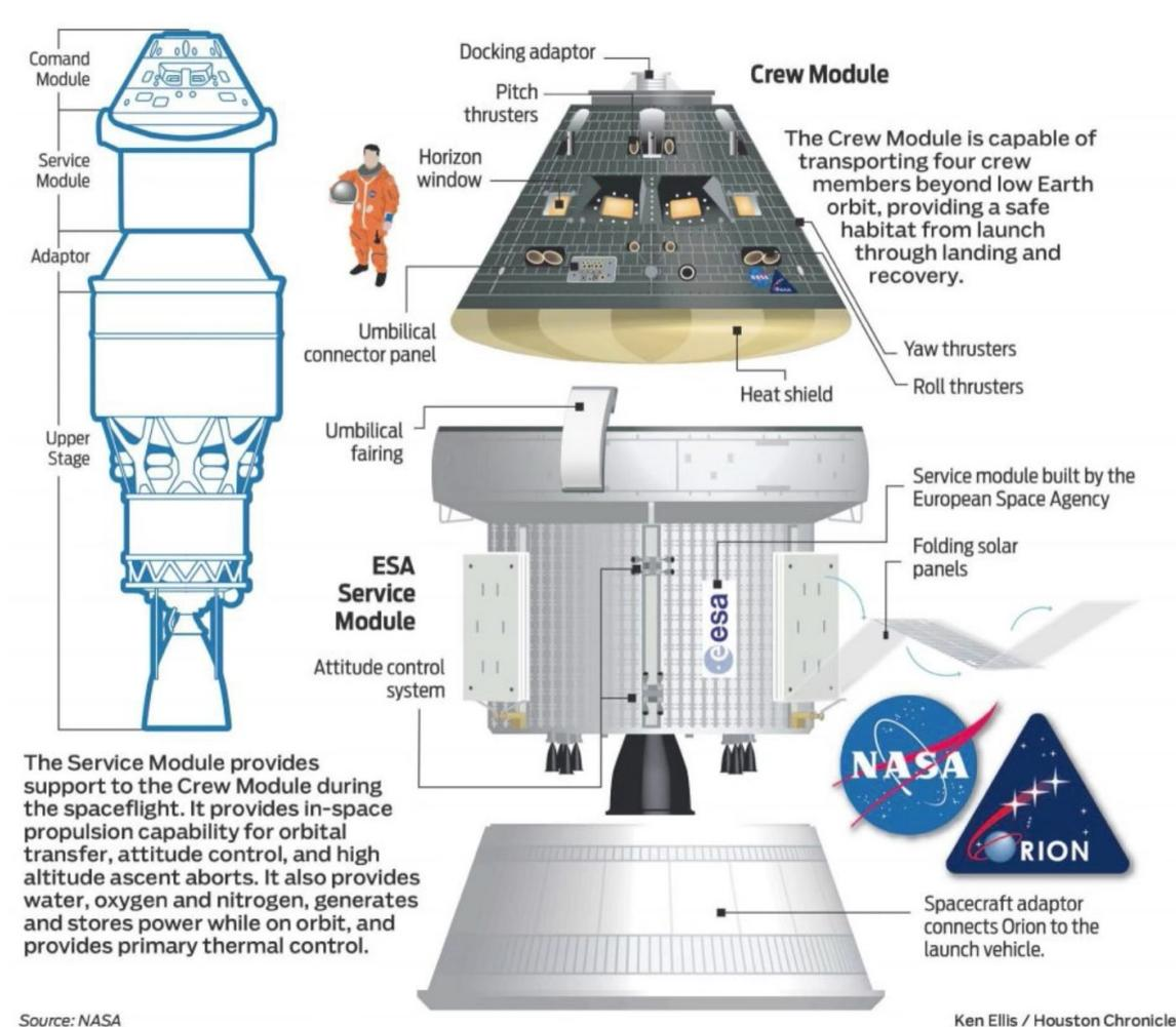
Figure 3.4.3. : Design of the Orion Crew Module
