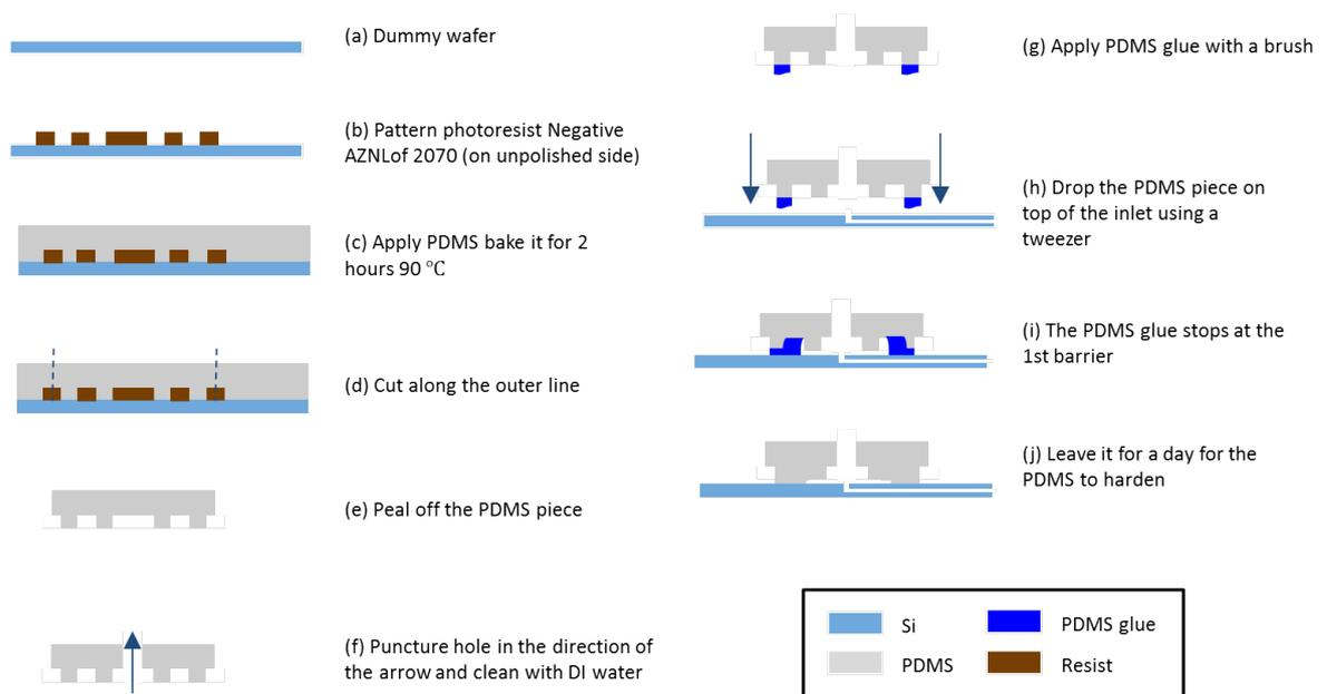
Figure C.2: flow chart PDMS seal
