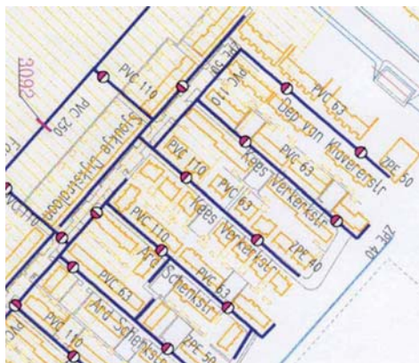
Figuur 15 - Boven een conventioneel vermaasd net en onder een modern vertakt net tot 40 mm PE voor de laatste aansluitingen
