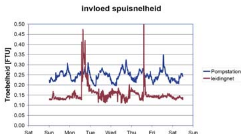
Figuur 11 - Invloed lage snelheid op mobiliteit sediment
