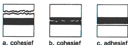
figuur 6.4 Breukmechanismen in lijmverbindingen
