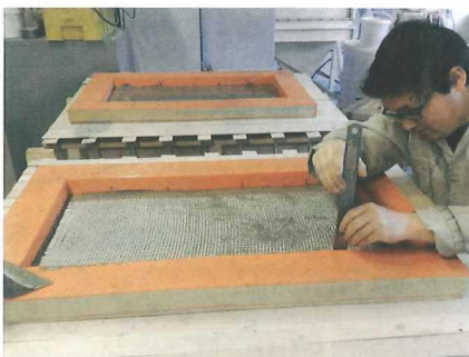
Abb. 6: links: Laminieren einer AR-Glas-Textilbewehrung vor der Verformung des Bauteils; Mitte: gebogene, entschalte und ausgerichtete Elemente; rechts: Schnittfläche mit vier Textilschichten
