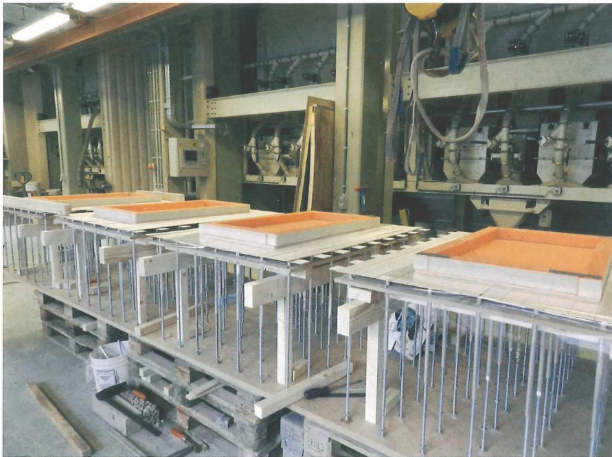
Abb. 5: Versuchsaufbau für die Untersuchung unterschiedlicher Parameter im Labor der TU Delft (Stevin 2): vier Silikonschalungen mit verstellbarer Neigung und Krümmung. Im Hintergrund ist die Betonmisch- und -dosieranlage zu sehen.
