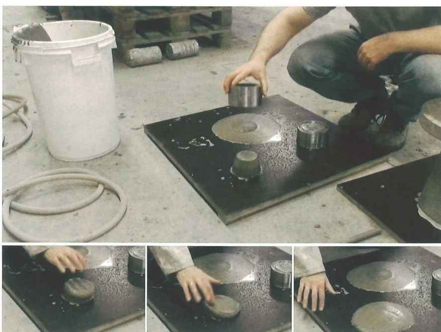
Abb. 8: Setzmaßversuche mit thixotroper Mischung: eine leichte Vibration durch Klopfen gegen den Kegel führt zu einem Anstieg der Fließfähigkeit des Frischbetons.
