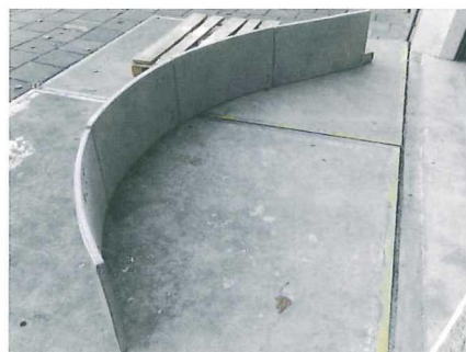
Abb. 6: links: Laminieren einer AR-Glas-Textilbewehrung vor der Verformung des Bauteils; Mitte: gebogene, entschalte und ausgerichtete Elemente; rechts: Schnittfläche mit vier Textilschichten
