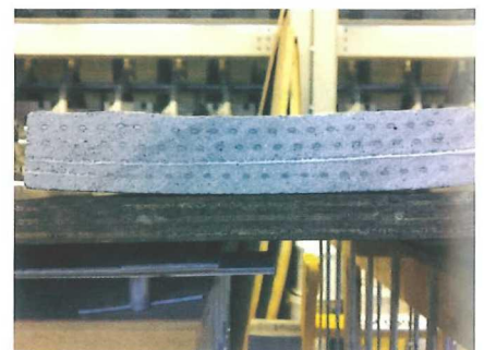
Abb. 6: links: Laminieren einer AR-Glas-Textilbewehrung vor der Verformung des Bauteils; Mitte: gebogene, entschalte und ausgerichtete Elemente; rechts: Schnittfläche mit vier Textilschichten
