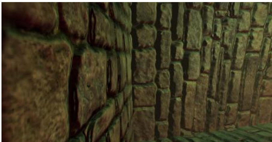
Figuur 15. Schijn van diepte gecreëerd door het toepassen van parallax mapping.
