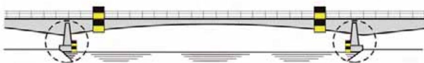
Figuur 5: Plaatsing referentietekens bij een symmetrische doorvaartopening
