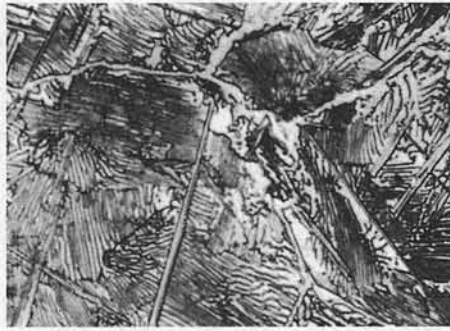
Figuur 4.11. Karakteristieke structuur van een normaalgegloeid 0,2 gew% C-staal (Ref. 3).
