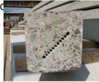
doorsnede energiepaal met kunststof lamel
