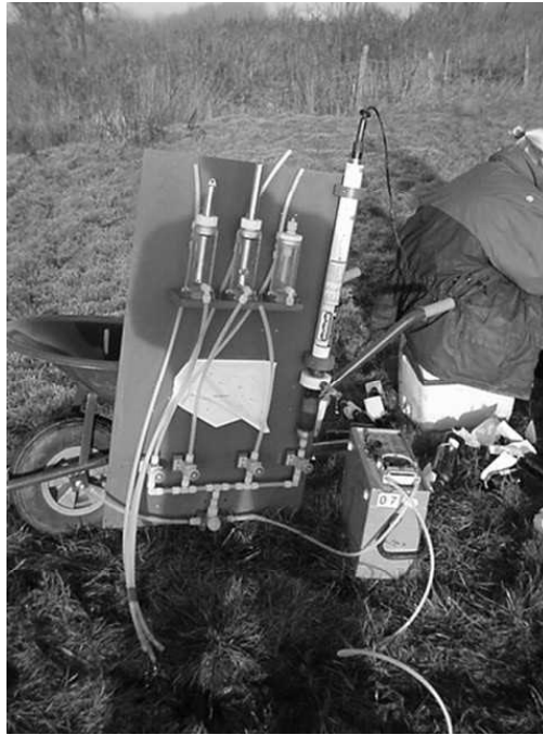
Fig. 2. De doorstroomcel met daaraan gekoppeld enkele sensoren (testen van het meetinstrument op voormalige stortplaats De Volgermeerpolder).
