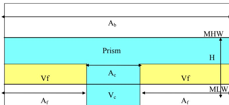
**Figure 3-3. Tidal prism schematisation**
