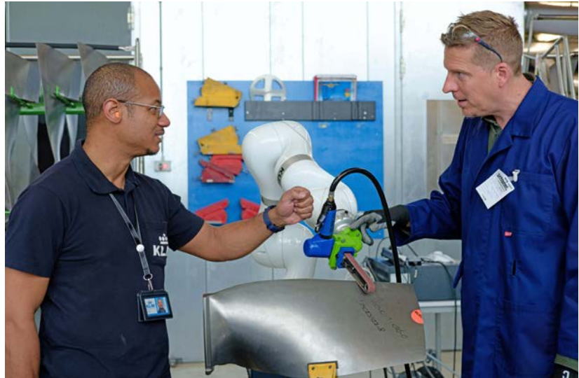
Afbeelding 2. Een van de co-creatieprocessen met een van de vakmensen van KLM, waarbij een KUKA-robotarm gebruikt werd om te onderzoeken welke mogelijke robot-ondersteuning daadwerkelijk zou bijdragen aan een aantrekkelijker werkproces.
