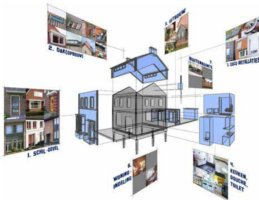
FIGUUR 1.4 Componentrenovatie (Bron: Bouwhulpgroep)
