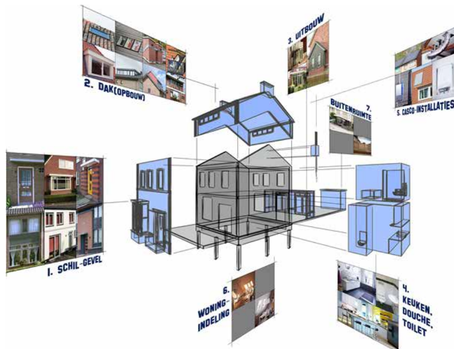
FIGUUR 2.23 Componentrenovatie (Bron: Bouwhulpgroep, 2015)
