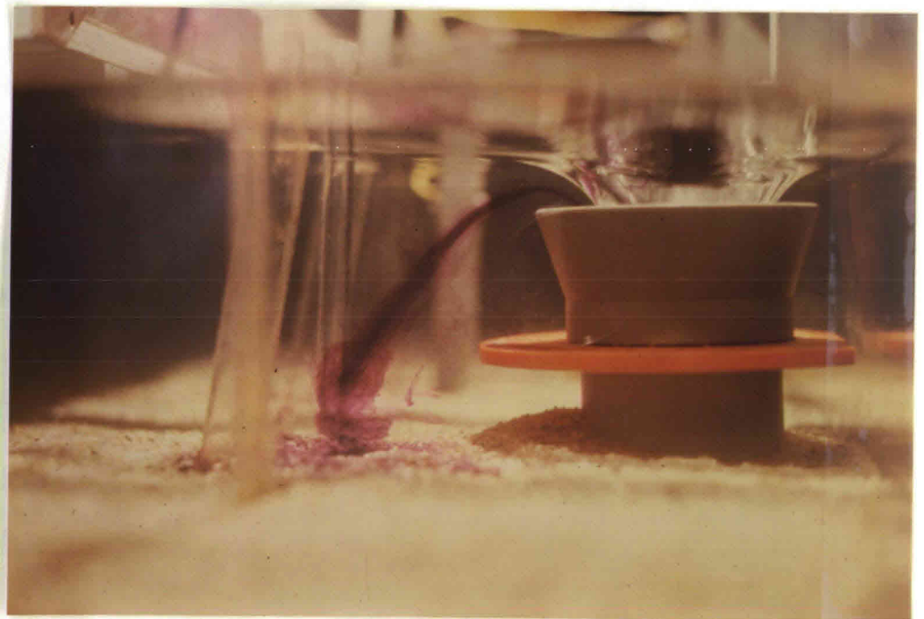
4. Wervelvorming bij ronde overvloei ondanks kraagconstructie
