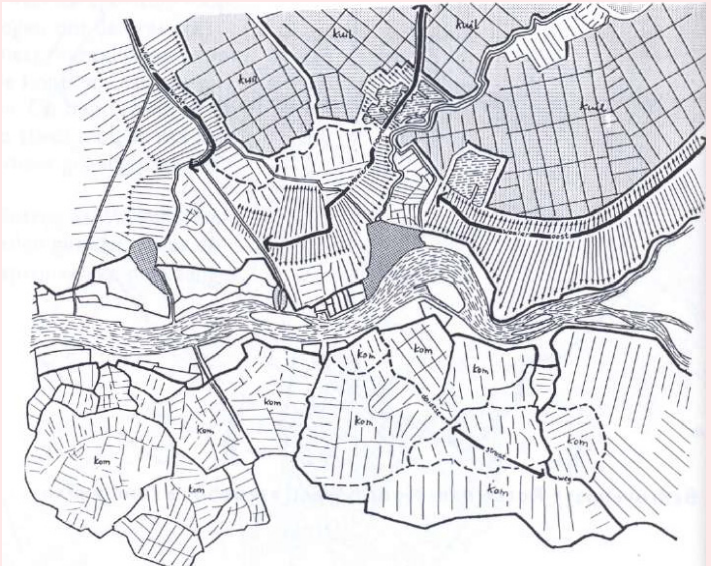
24. Verkavelingsstructuur van Rotterdam (afbeelding: Frits Palmboom, 1987). Goed te zien is dat IJsselmonde stukje bij beetje bedijkt is, wat leidt tot de ringvormige dijenstructuur. / Parcellation of Rotterdam (via Frits Palmboom, 1987). IJsselmonde, to the south of the river Maas, has been diked in bit by bit, leading to ring-shaped dikes.
