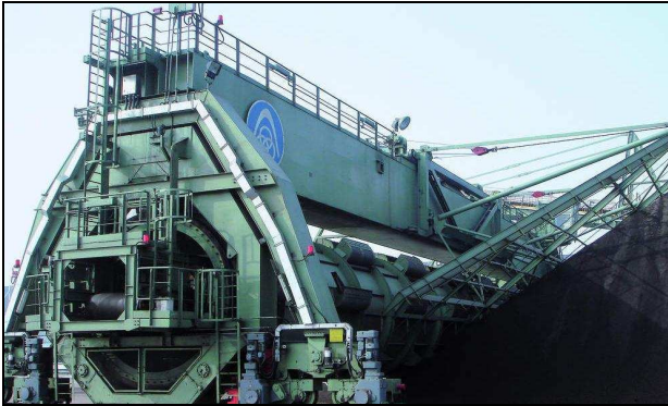
Figuur 2.7a: drum reclaimer
