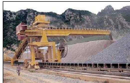
Figuur 1.1b: luffing stacker bij het storten van zand
