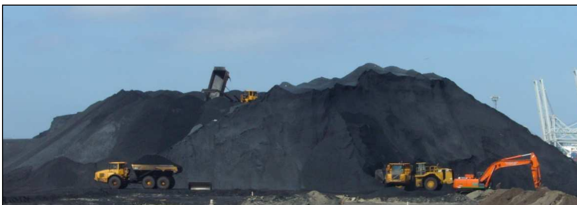
Fig 3.4: opslag gecreëerd met dumpers en shovels op het werkterrein van EMO
