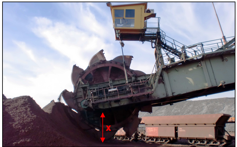
Figuur 7.3: de afstand (x) die het emmerwiel onder de arm uitsteekt
