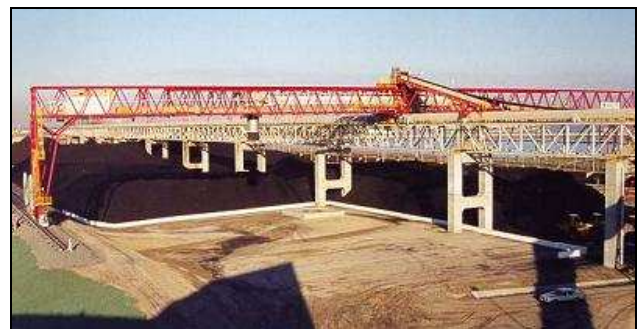
Figuur 1.4b: bridge stacker in San Pedro (Californië)
