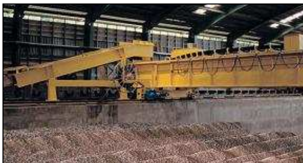
Figuur 1.4a: bridge stacker voor afgesloten opslag
