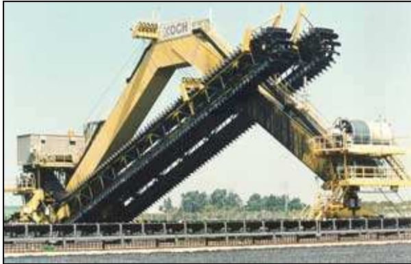
Figuur 2.4a: portal scraper
