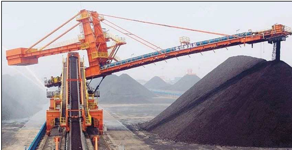
Figuur 1.3: slewing stacker voor het storten van kolen
