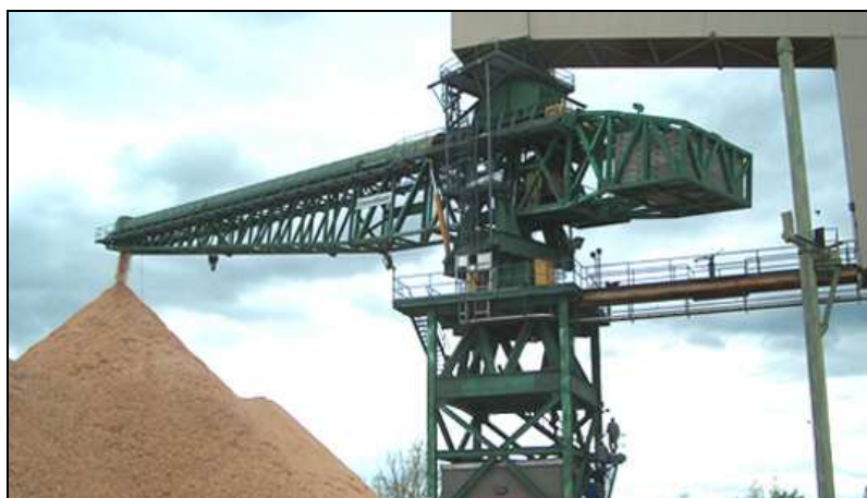
Figuur 1.2: radial stacker
