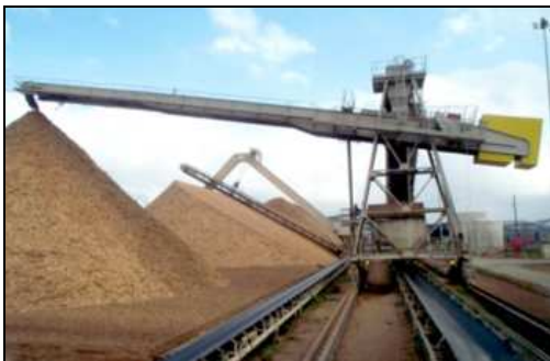
Figuur 1.1a luffing stacker bij het storten van houtsnippers
