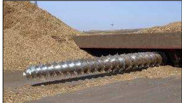
Figuur 2.9b: de schroef van de traversing screw reclaimer
