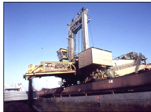
Figuur 2.5: lichtbelader (EMO 2 , 2010)
