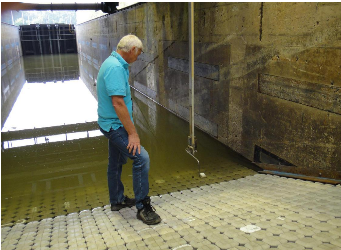
Figuur 3.3 De profielvolger tijdens een profielmeting
