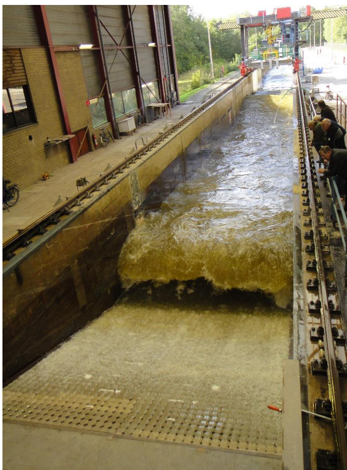
Figuur 4.1 Beproeven van de Hillblocks in de Deltagoot
