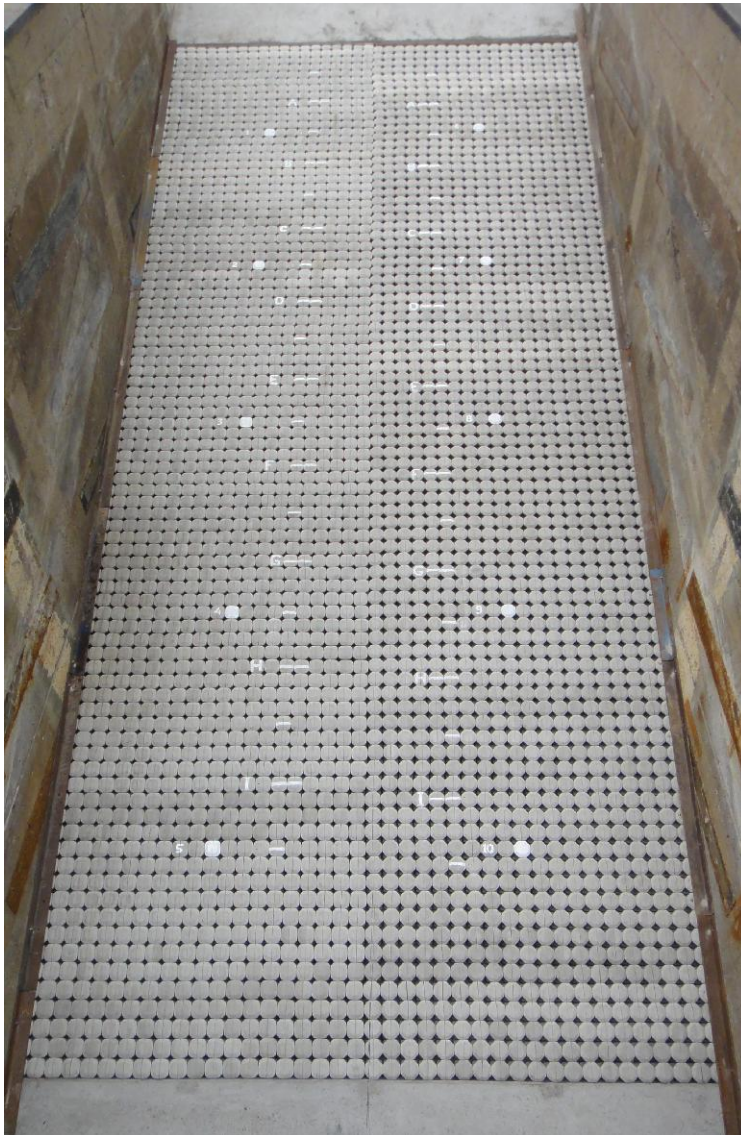
Figuur 3.2 Ligging van de Hillblocks in de Deltagoot (links Basisblock, rechts Slimblock)
