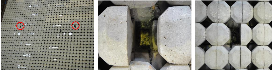
Figuur 4.2 Kunstmatig aangebrachte schade voor Test T015 (v.l.n.r.: overzicht, detail Basisblock, detail Slimblock, de middelste en rechter foto zijn 180° gedraaid t.o.v. de linkerfoto)
