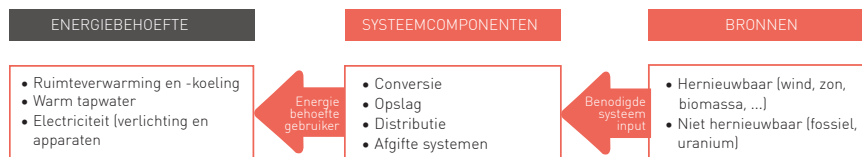
FIG. 1 Keten voor energievoorziening in de gebouwde omgeving 1 .
