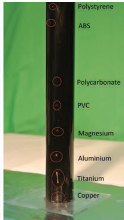
FIG. 1 Links: MDS technologie om flakes in één stap in vijf soorten te scheiden. Rechts: het principe van de scheiding in het laboratorium voor verschillende plastics (en metalen).
