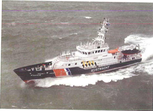
Figuur 9 Kustwachtvaartuig volgens het Enlarged Ship Concept (copyright Flying Focus)
