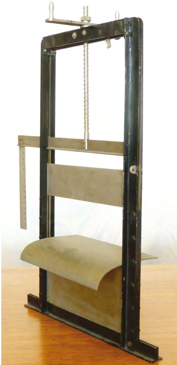
Figuur 2 | Model van de Romijn-meetoverlaat.
