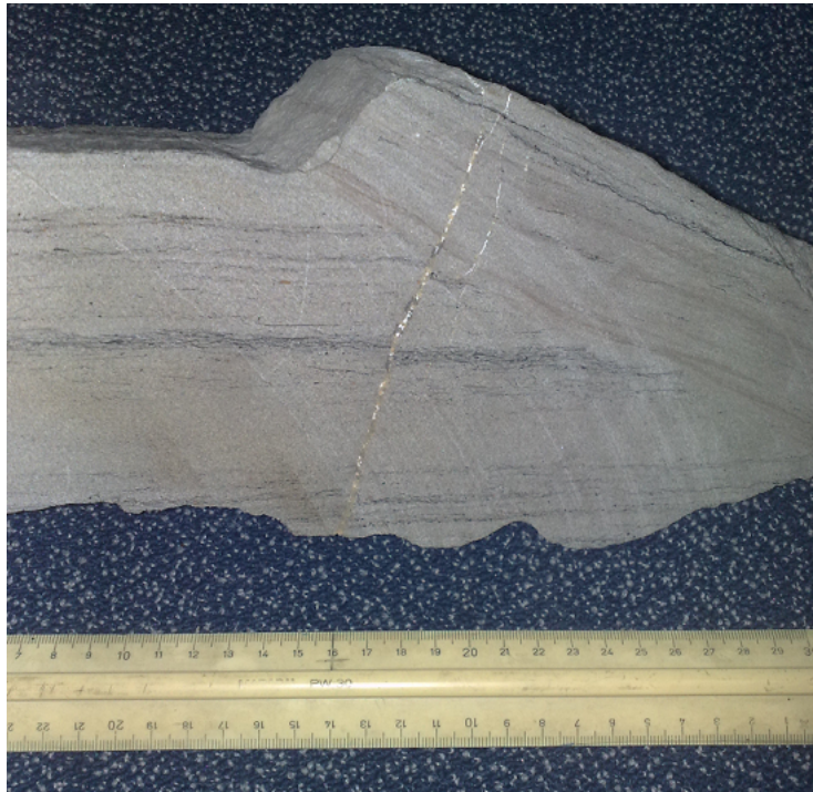
Figuur 7: Typische afmetingen van een breuk in de Nederlandse ondergrond.
