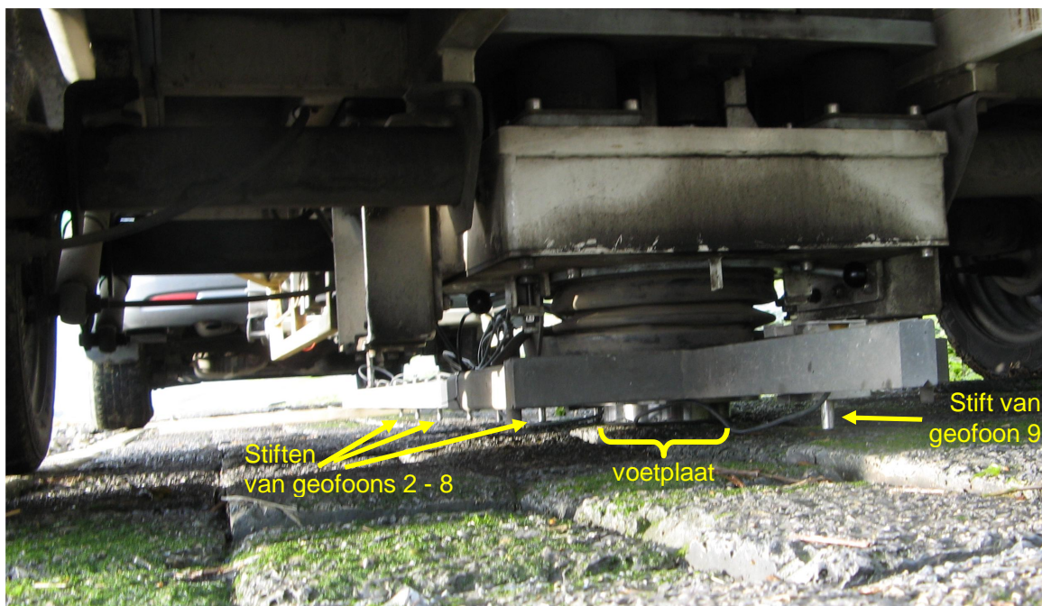
Figuur 2.7 Vanaf de achterzijde zijn onder de aanhangwagen de voetplaat van het valgewicht en de stiften van de geofoons te zien
