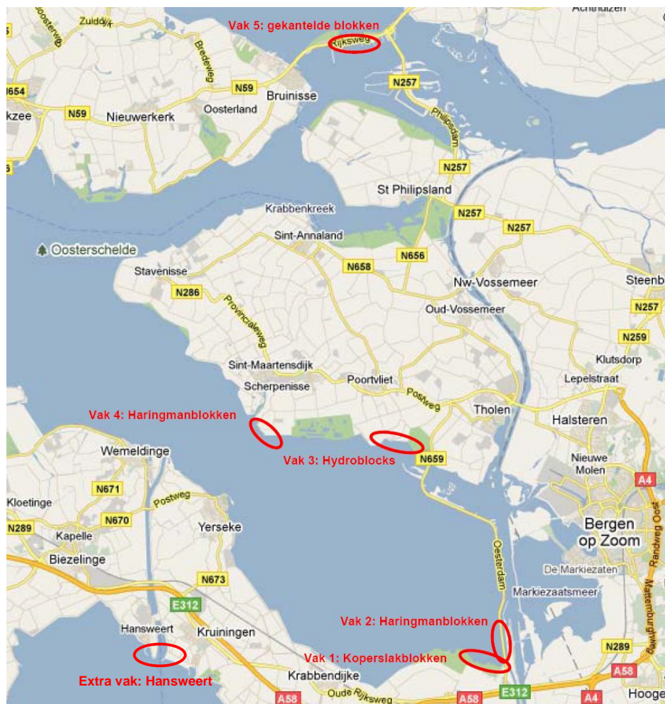
Figuur 2.2 Locaties en steentypen van de metingen uitgevoerd in 2010 (bij Hansweert zijn alleen trekproeven uitgevoerd)
