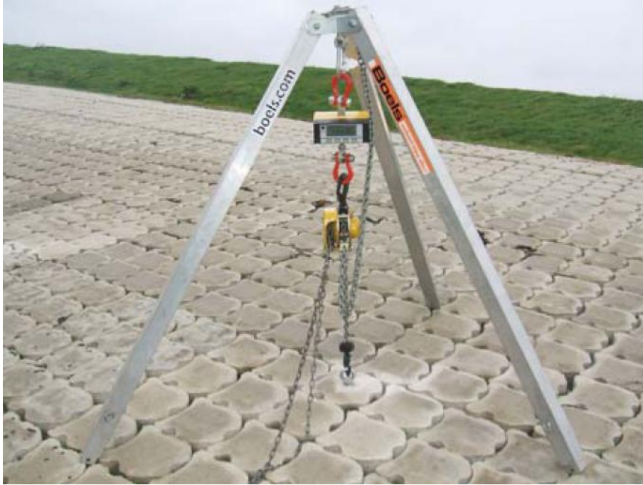
Figuur 2.3 Driepoot met handtakel en digitale unster
