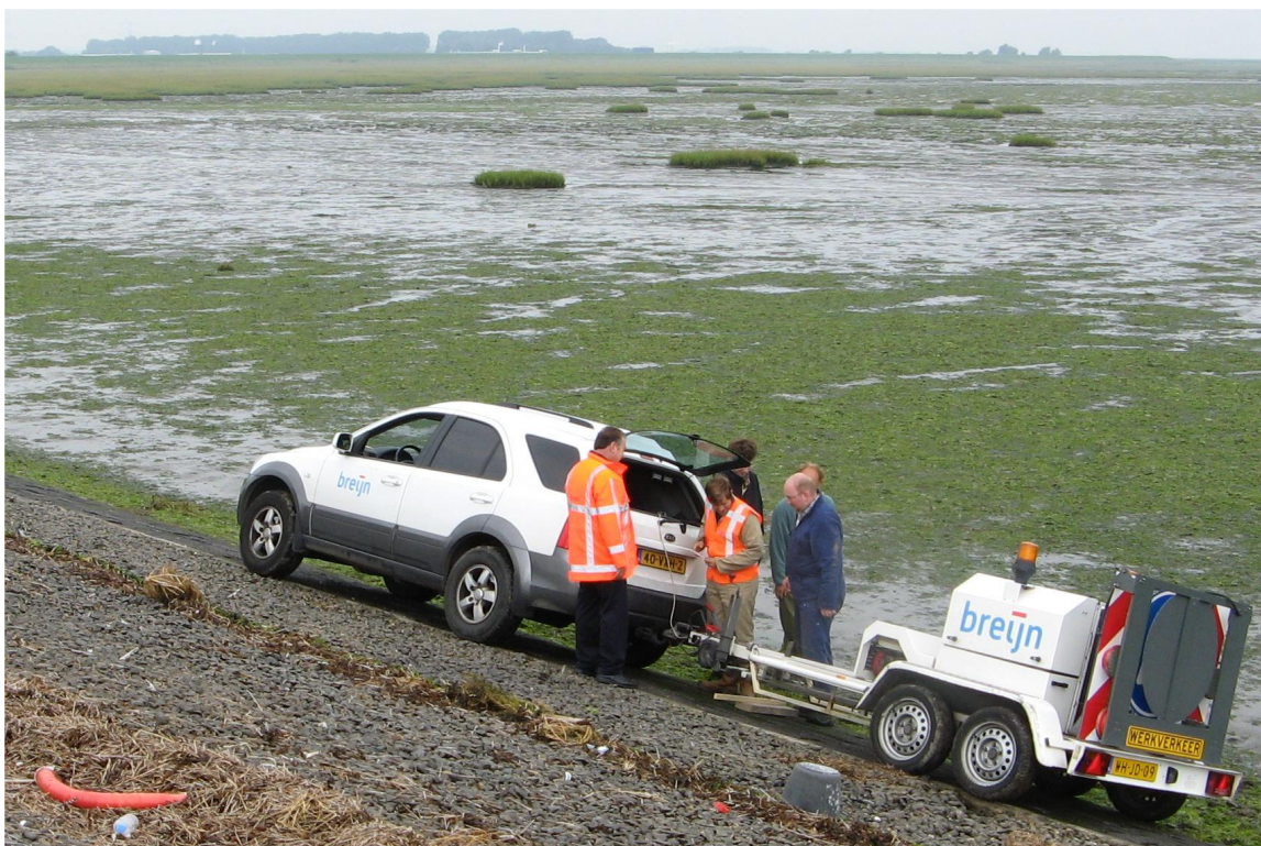
Figuur 2.6 Voertuig met aanhangwagen met apparatuur voor VGD-metingen
