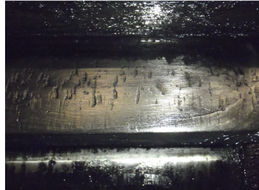
Fotonr. 17: vreesporen aanwezig – detail
