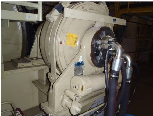
Fotonr. 8: druk voor rem niet aangegeven
