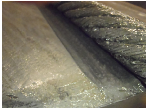
Fotonr. 11: slijtage geleidingsblok – detail
