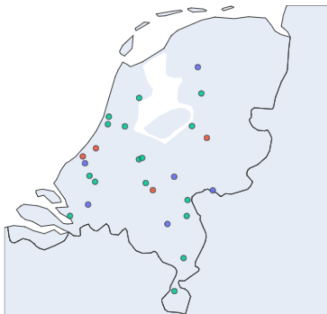
Figuur 9: Locaties van de casuswoningen. In de woningen op de groen gekleurde locaties zijn metingen van de warmteweerstand van de gevel uitgevoerd, in de woningen op de rood gekleurde locaties is de luchtdichtheid gemeten en in de woningen op de blauw gekleurde locaties is zowel de warmteweerstand als de luchtdichtheid bepaald. Omdat enkele woningen dicht bij elkaar liggen zijn niet alle 38 locaties zichtbaar in de afbeelding.
