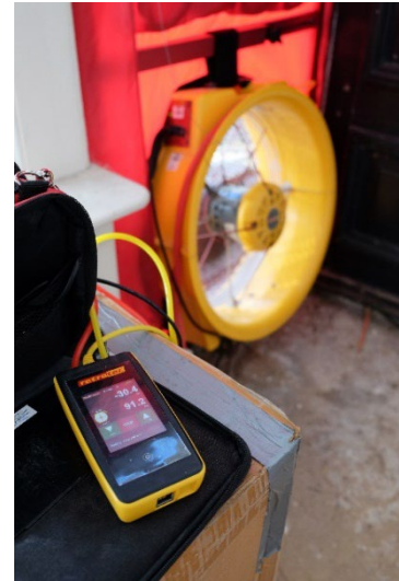
Figuur 6: Aflezen drukverschil en lucht volumestroom.
