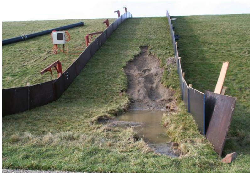
Figuur 3.7 Geometrische overgang (weinig invloed)
