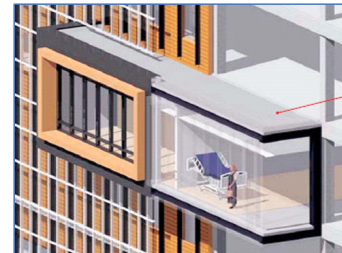
Figuur 21. De “Lade” constructie.
