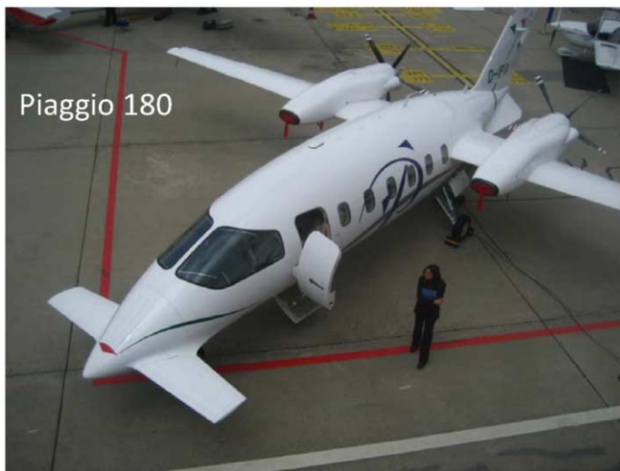
Fig 6. The Piaggio 180 canard configuration
