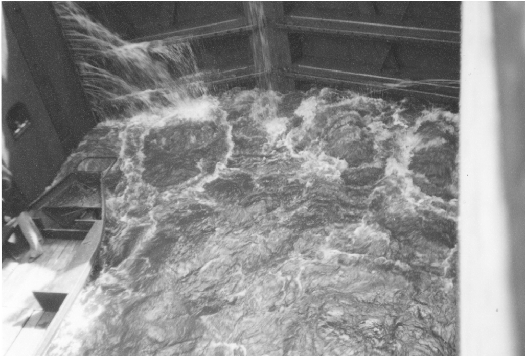
Foto 6.4 Stroombeeld tijdens vullen d.m.v. deuropeningen van sluis in het Noord Willemkanaal
