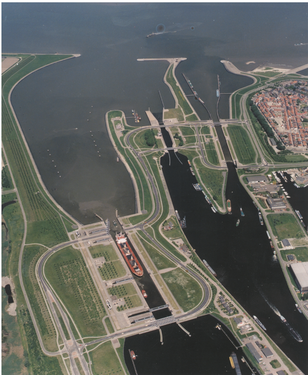
Foto 5.1 Layout van sluiscomplex te Terneuzen met (v.l.n.r.) grote zeesluis, Middensluis en binnenvaartsluis als verbinding van Westerschelde (boven) met Kanaal van Gent naar Terneuzen (onder)
