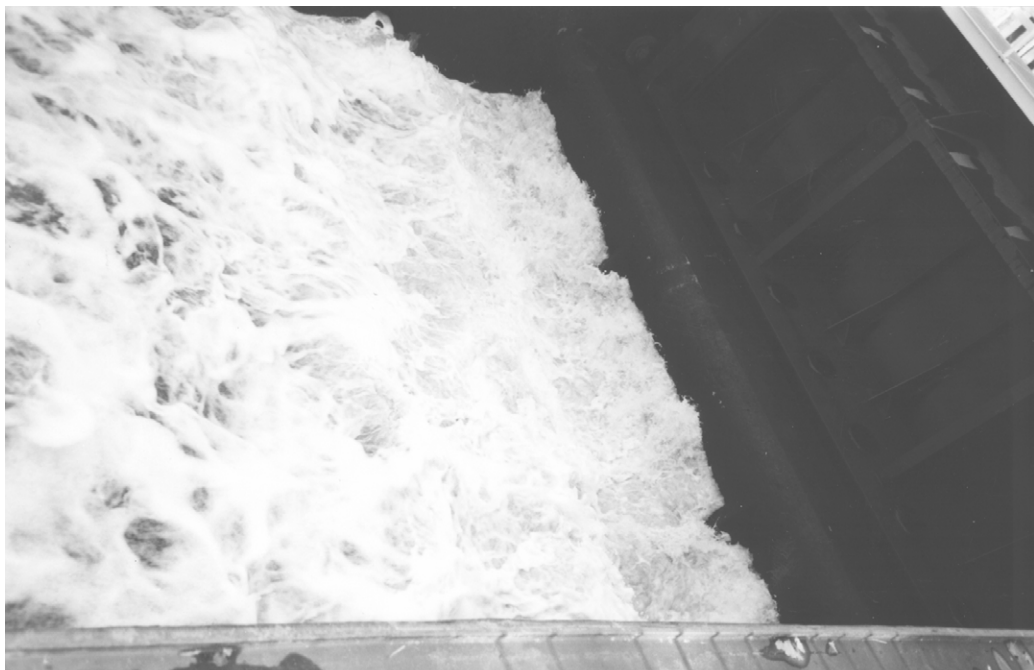
Foto 6.3 Stroombeeld tijdens vullen d.m.v. heffen bovendeur van sluis te Eefde
