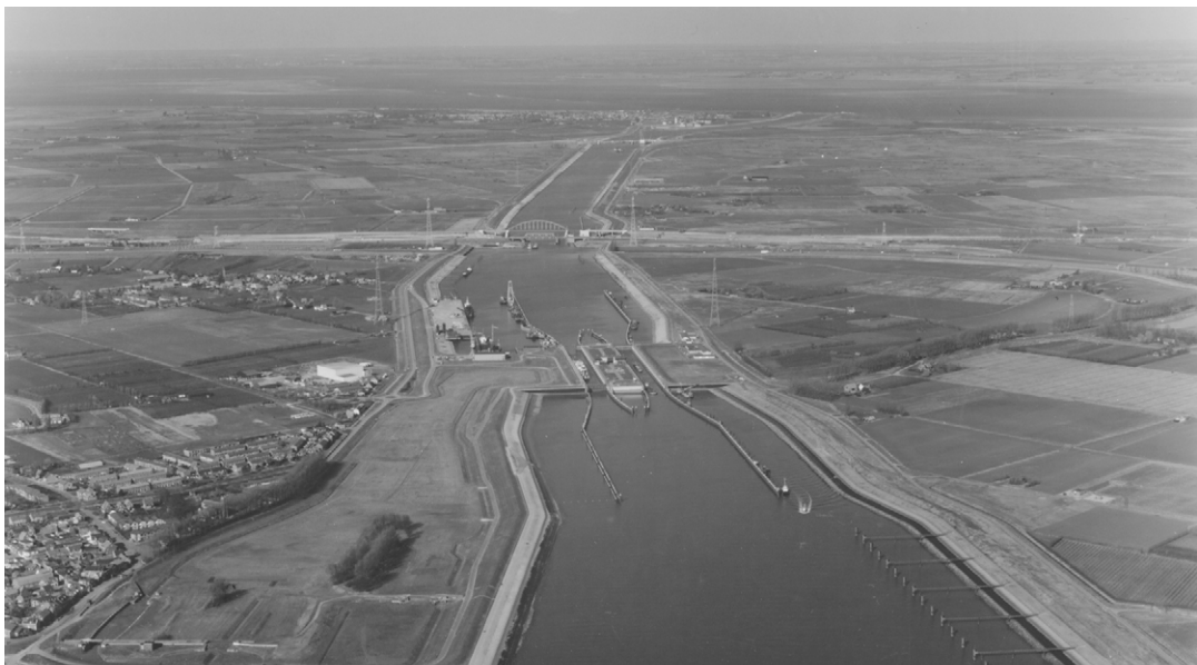
Foto 5.6 Layout van twee duwvaartsluizen te Hansweert In Kanaal door Zuid Beveland
