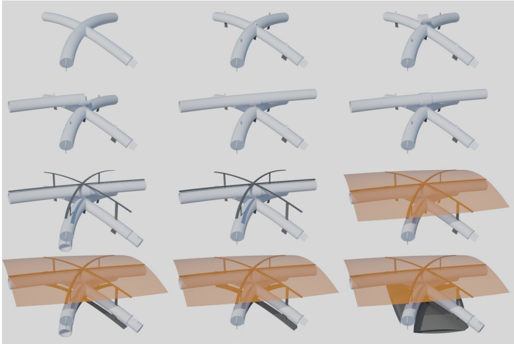
Figuur 72 – Gehele montagevolgorde, van bovenaf gezien.
