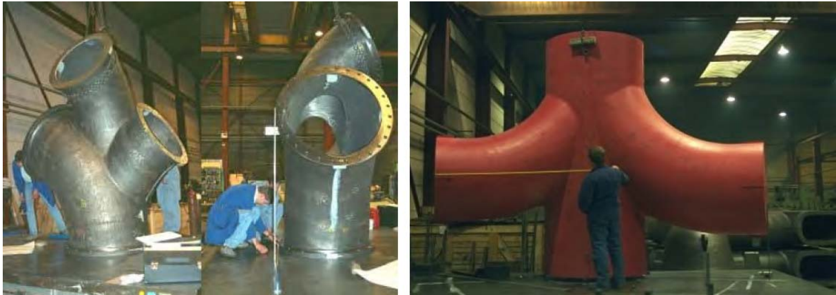
Figuur 64 – Gietstukken van een complexe knoop.
