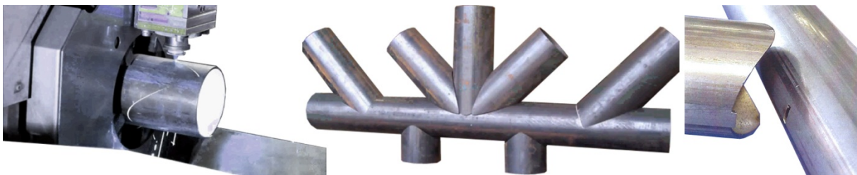
Figuur 65 – V.l.n.r.: laser snijder, in elkaar zetten staven tot knopen, hulp montage.
