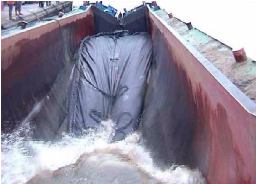
Fig.7 Videobeeld proef met ongelijkmatig beladen geocontainer juist voor het vallen uit de splijtbak
