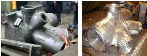
Figuur 97 - Gegoten knooppunten
