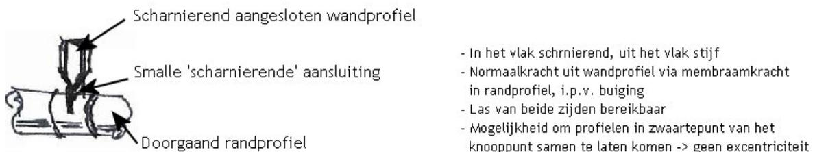
**Figuur 187 - Mogelijkheid 'scharnierende' verbinding**
