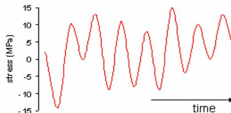
Figuur 165 - Mogelijk verloop windbelasting over de tijd
