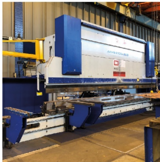
'Kantbank' using Press Forming
