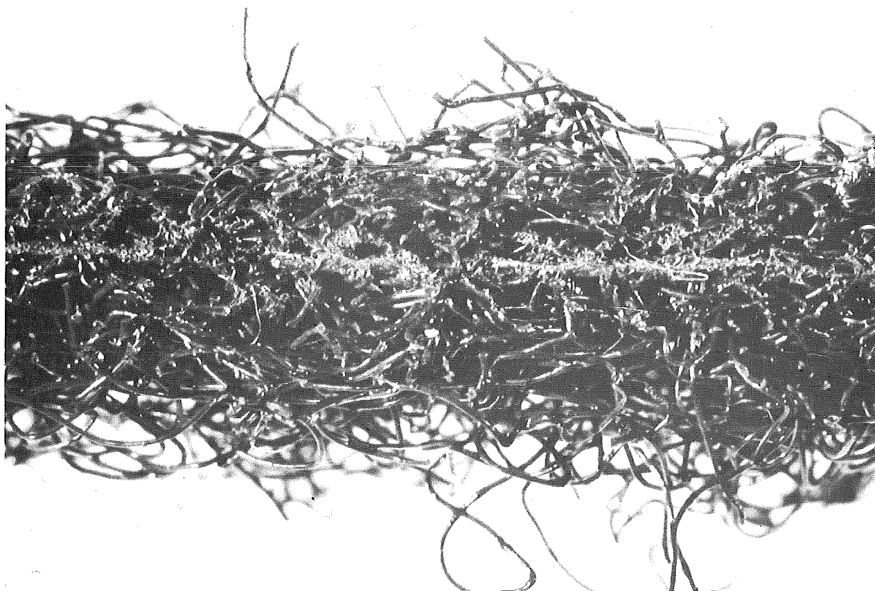
Foto 11 Zijaanzicht vlies met draagweefsel (10 x vergroot)
