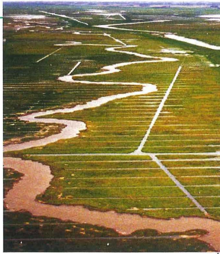
Vliegerfoto van de slenkvormige laagte die voor de inrichting van de proefverkweldering is gegraven. (2000)
