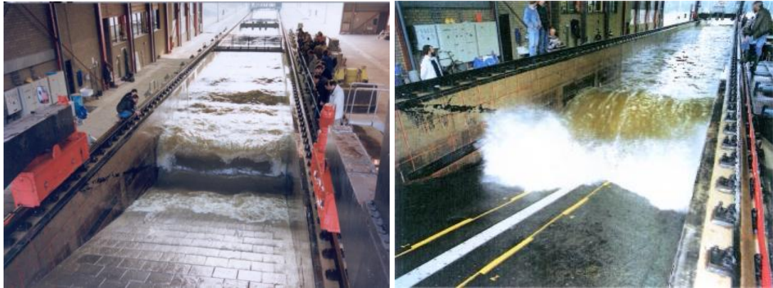
Figuur 2, Deltagootproeven met vierkante blokken (Wouters, 1991) (linker foto) en asfalt (Derks en Klein Breteler, 1992) (rechter foto)
