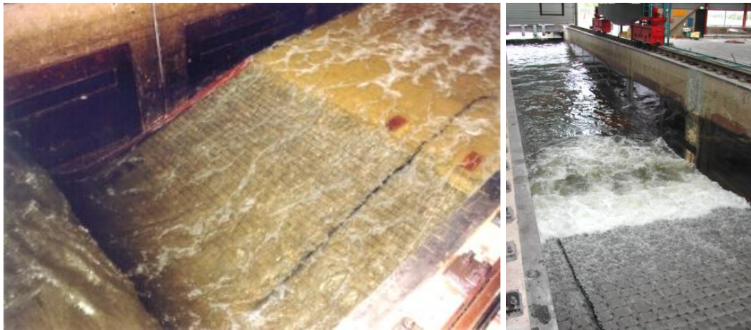
Figuur 3, Deltagootproeven met blokken op hun kant (Klein Breteler, 2000) (linker foto) en Hydroblocks (Klein Breteler e.a. 2006a) (rechter foto)
