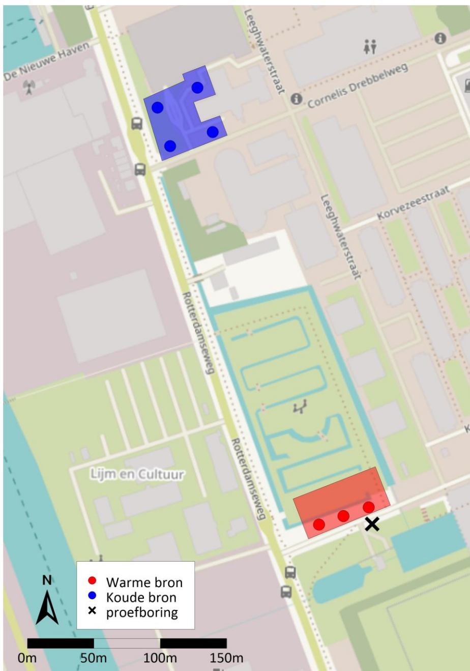
Figuur 1.1 | Zoekgebieden voor de HTO-bronnen (blauw: lauwe bronnen, rood: hete bronnen) en de locatie van de proefboring (zwarte kruis).
