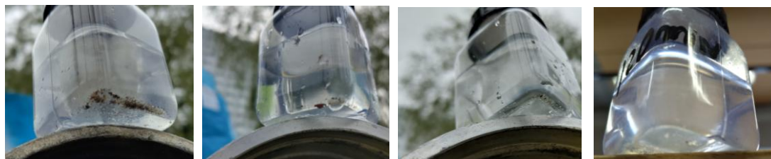
Figuur 4.2 | Zandhoudendheid van 10 m 3 water bij een debiet van 60 m 3 /uur. Van links naar rechts: 1) direct na verversen, 2) na een half uur pompen, 3) na één uur pompen en 4) na twee uur pompen.
