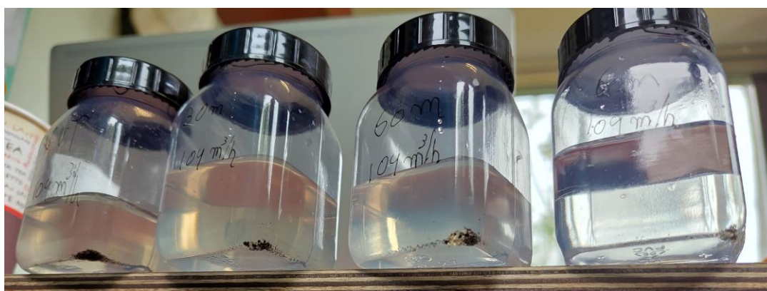
Figuur 4.4 | Zandhoudendheid van 10 m 3 water bij een debiet van 104 m 3 /uur. Van links naar rechts: 1) direct na verversen, 2) na een half uur pompen, 3) na één uur pompen en 4) na twee uur pompen.
