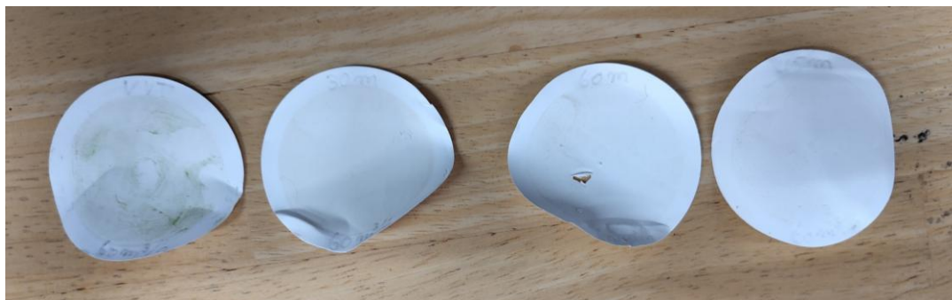
Figuur 4.6 | MFI-filters na het uitvoeren van de handmatige test bij 60 m 3 /h. Van links naar rechts 1) direct na het verversen van de bron, 2) na een half uur pompen, 3) na één uur pompen en 4) na twee uur pompen
