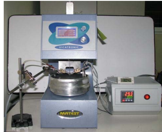
Şekil 3. Sıcaklık kontrollü Vicat aleti (Temperature controlled Vicat apparatus)
