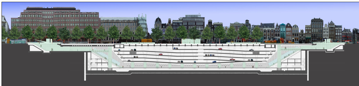
Figuur 1.4; Langsdoorsnede van station Rokin gekeken naar de belending die gesitueerd is aan de oostzijde van het station (bron; Benthem Crouwel Architects).
