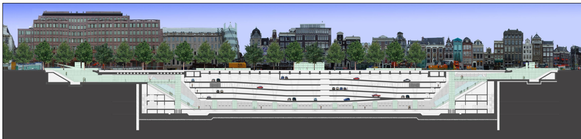
Figuur 3.2; Langsdoorsnede van station Rokin gekeken naar de belending die gesitueerd is aan de oostzijde van het station (bron; Benthem Crouwel Architects).
